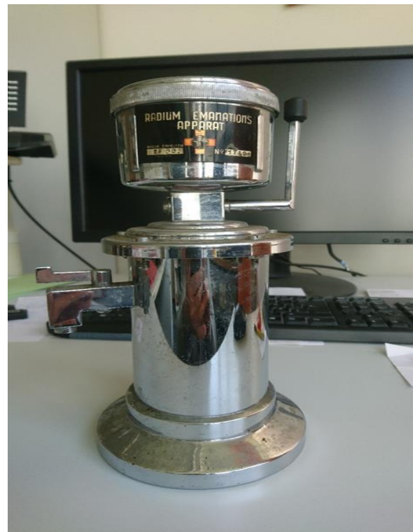
Bild 3: Radium-Emanations-Apparat (Dachbodenfund in einem alten Wohnhaus)
