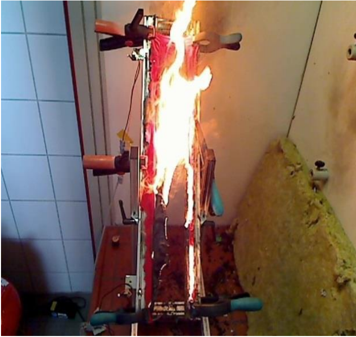
Bild 9: abgebranntes Kinderfaschingskostüm (UB 2019-09)
