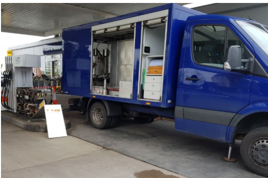
Abb. 1: Eichung einer Straßenzapfsäule unter Einsatz von Volumennormalen
