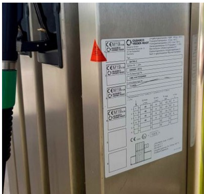
Abb. 4: Kennzeichnung einer instandgesetzten Straßenzapfsäule durch Anbringung eines Instandsetzerkennzeichens (rotes Dreieck)
