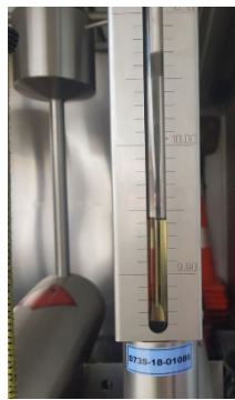
Abb. 1: Eichung einer Straßenzapfsäule unter Einsatz von Volumennormalen
