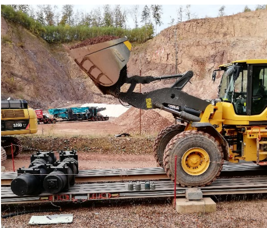
Abb. 2: Eichung von Straßenfahrzeugwaagen mit Massennormalen
