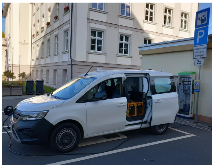
Abb. 3: Eichung einer öffentlichen Elektroladesäule
