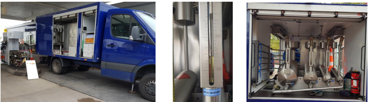
Abb. 1: Eichung einer Straßenzapfsäule unter Einsatz von Volumennormalen
