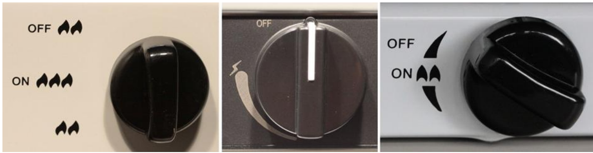
Abbildungen 1-3: Mangelhafte Markierungen an den Drehreglern (TLV-Bildaufnahmen)
