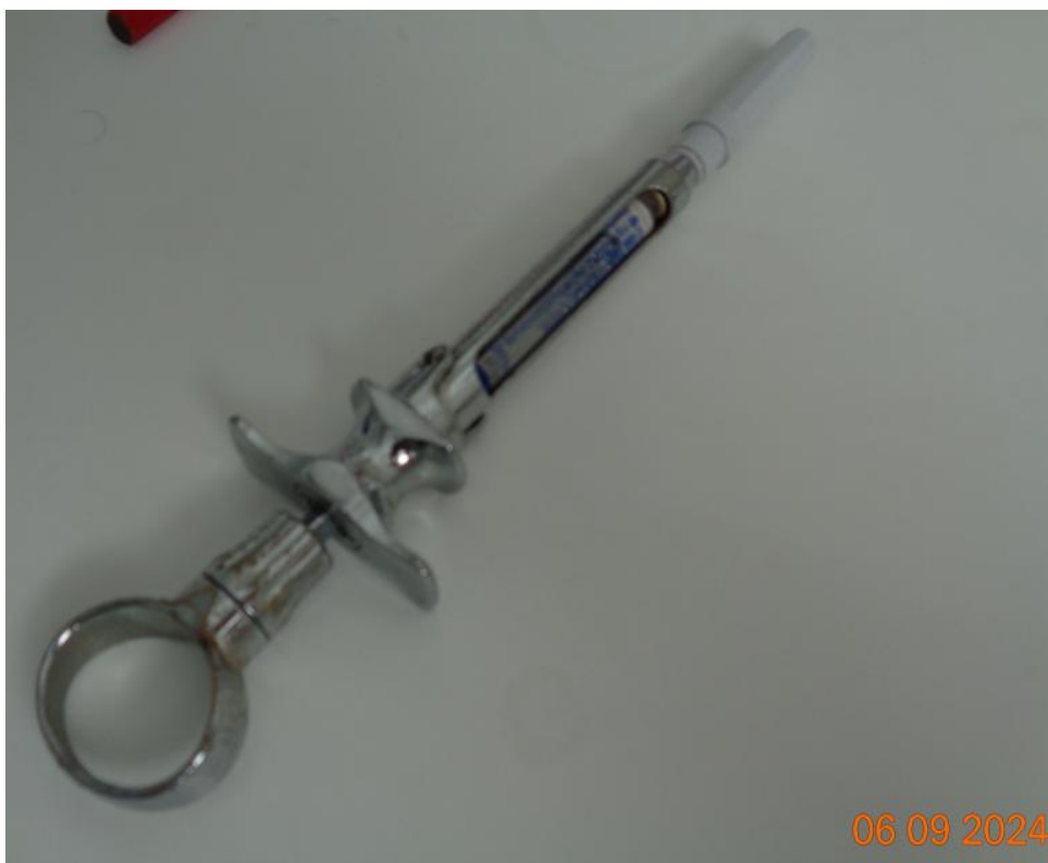
Abbildung 14: Zylinderampullenspritze mit Rostanheftungen (TLV-Bildaufnahme)
